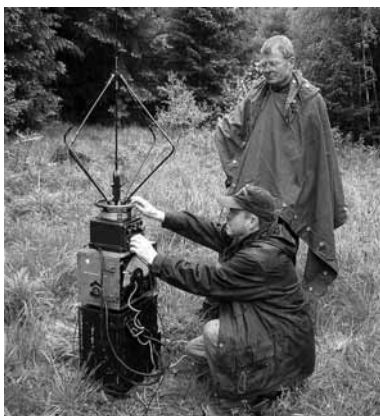
Рис. 25. КВ (0,19–25 МГц) радиопеленгатор Fu.NPEa/c фирмы Rohde & Schwarz в полевых условиях.
