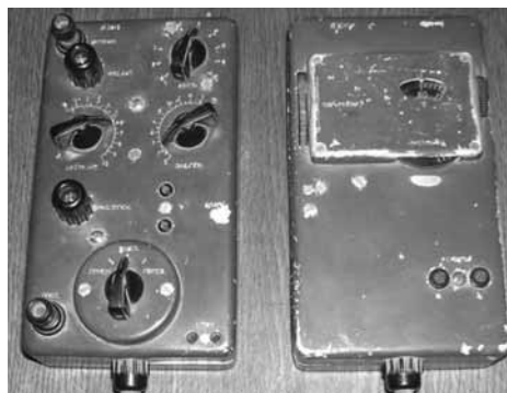
Рис. 21. Отечественная радиостанция 4ТУД «Белка» (вид снаружи).
