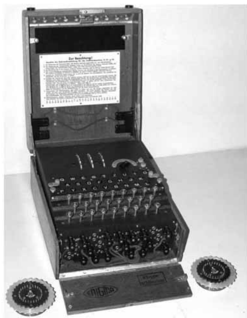
Рис. 3. Трехроторная армейская «ламповая» шифрмашинa Энигма
