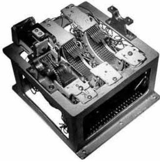
Рис. 14. Сохранившийся узел японской шифрмашины «Purple» с шаговыми искателями.
