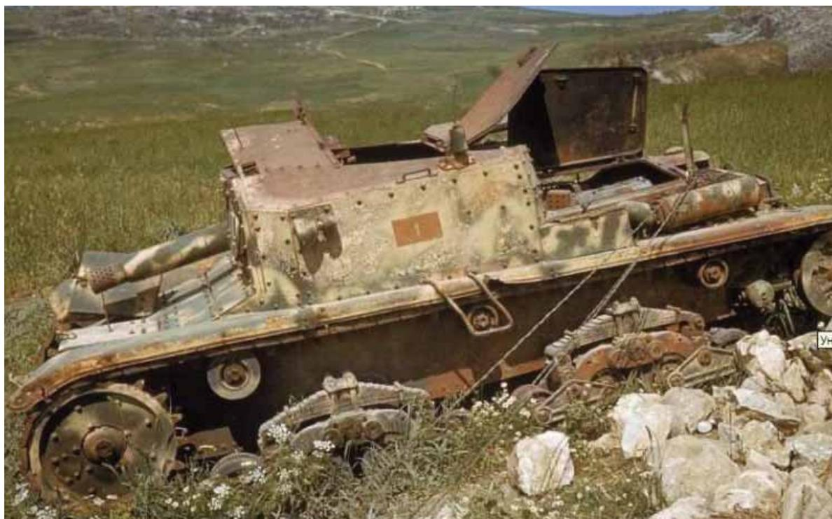
Уничтоженная войсками союзников итальянская САУ Semovente da 75/18. САУ подбита во время сражения за Эль-Геттар. Судя по тактическому знаку, машина принадлежала командиру 1-й батареи. Эта машина относилась к классу штурмовых орудий, вооружалась 75-мм орудием Obice da 75/18 modello 34 и являлась удачной попыткой использования шасси безнадежно устаревшего к тому времени танка Fiat М 13/14/15.
