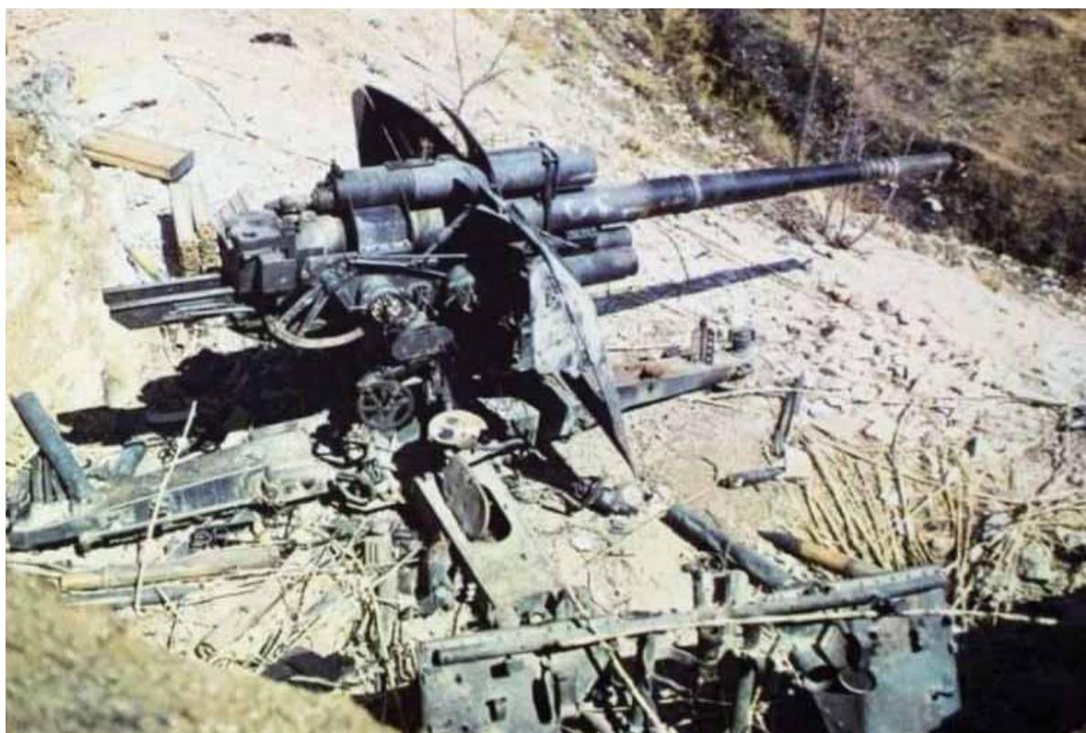
Немецкая 88-мм зенитная пушка Flak-18, брошенная на позиции. На позиции разбросанные неиспользованные снаряды. На переднем плане — часть передка. Затвор у орудия снят.
