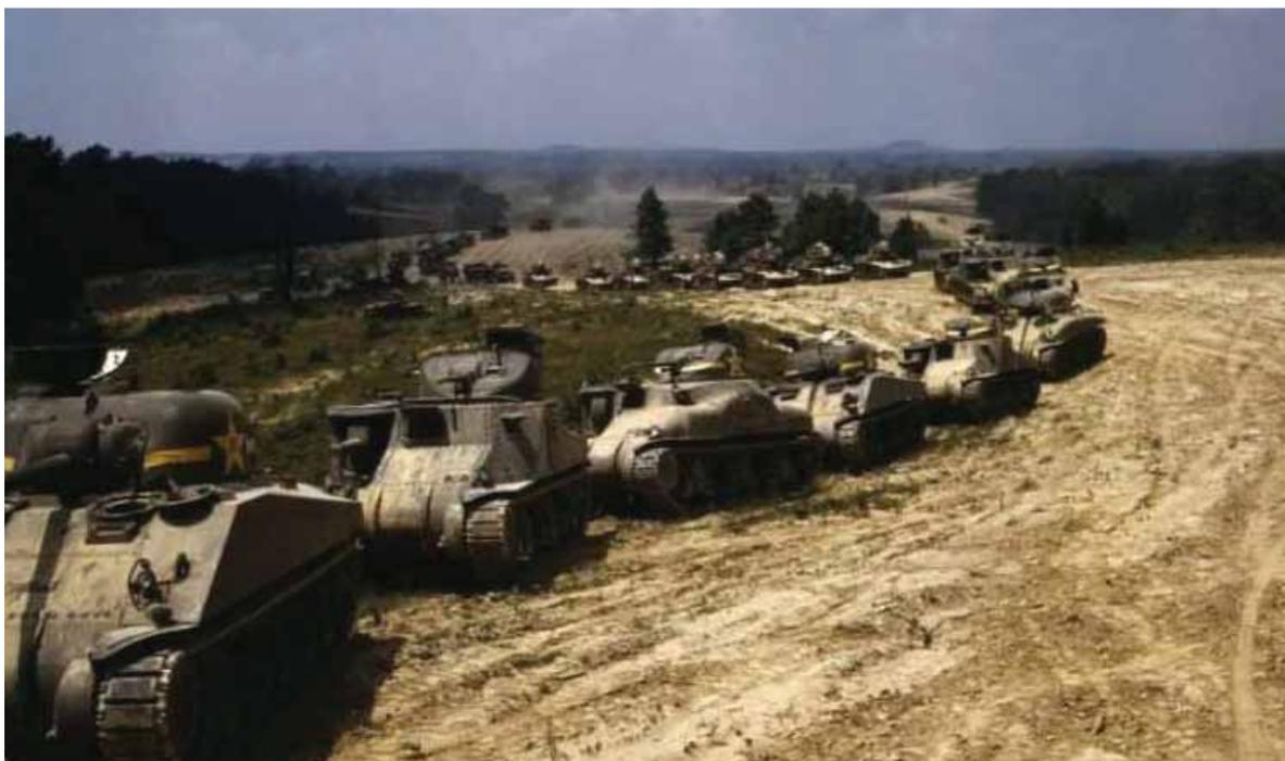
Американские средние танки «Шерман» М4А4 (первый и четвертый танки) и М4А1 (шестой); «Ли»: М3А1 (третий и седьмой танки) и М3А2 (второй, пятый, восьмой и девятый). На заднем плане — легкие танки М3 «Стюарт» и бронетранспортеры М2.
