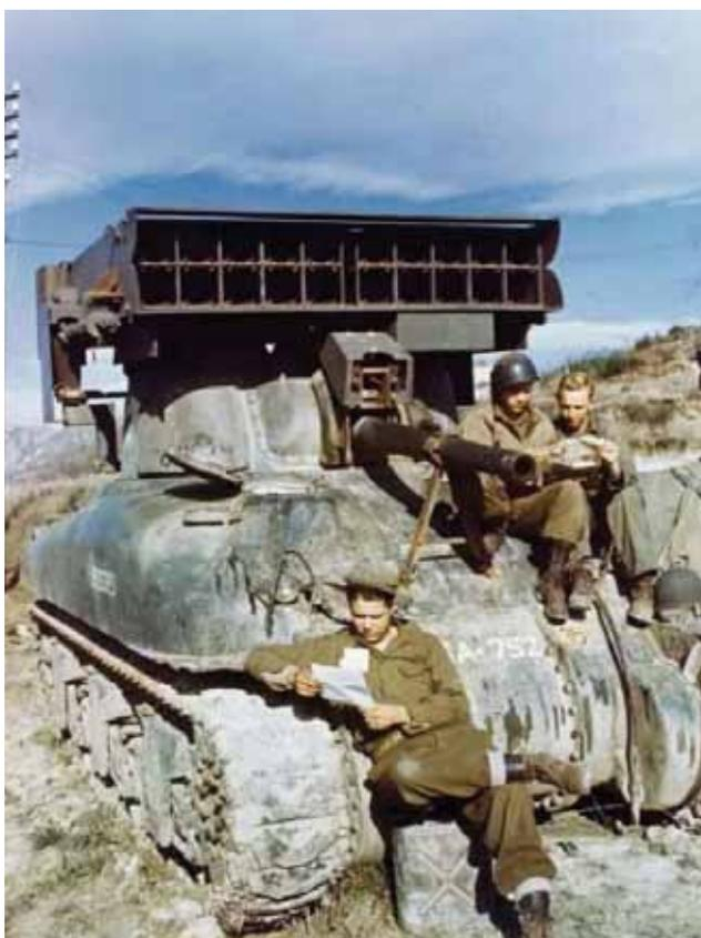
Американский танк М4А1 «Шерман» с установленной над башней системой залпового огня Т40 (М17) Whiz-Bang. 3-й (ракетный) взвод 752-го танкового батальона армии США.
