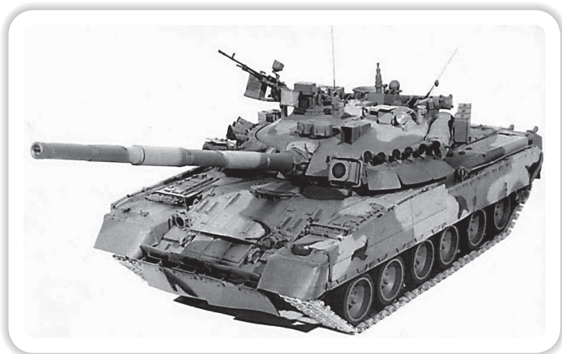
Т-80 — первый в мире серийный танк с газотурбинным двигателем
