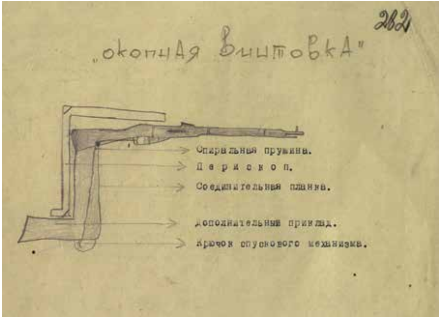
Рис. 7. Схема «окопной винтовки» из приложения к протоколу допроса словенского военнопленного Иозефа Хорвата 19
