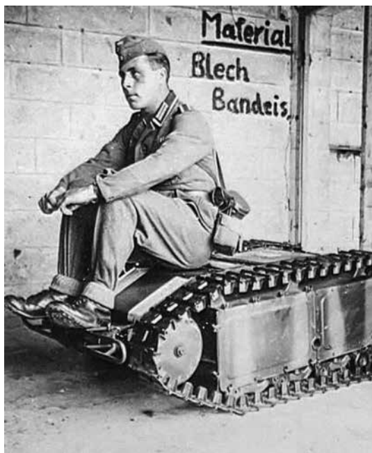
Немецкая радиоуправляемая танкетка «Голиаф». Начинялась взрывчаткой и предназначалась для подрыва укреплений.
